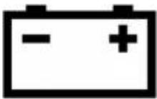
*il simbolo raffigurato, se collocato su una spia di colore rosso, permette di capire se la batteria viene correttamente ricaricata o meno dall'alternatore*
