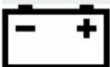
Una spia di colore rosso contrassegnata dal simbolo di figura, se accesa durante la marcia, indica che l'alternatore non sta ricaricando la batteria
