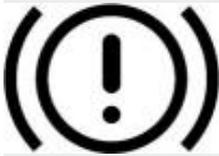
Una spia di colore rosso contrassegnata dal simbolo di figura, se accesa durante la marcia, comporta di provvedere rapidamente a una manutenzione o riparazione dell'impianto frenante
