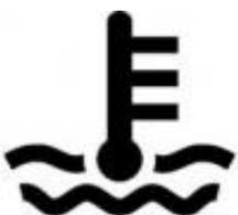
*Una spia accesa di colore rosso, contrassegnata dal simbolo di figura, indica un eccessivo riscaldamento del motore*
