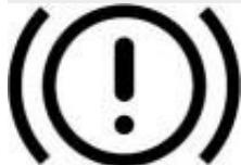
Una spia di colore rosso contrassegnata dal simbolo di figura, se accesa durante la marcia, comporta di provvedere rapidamente a una manutenzione o riparazione dell'impianto frenante
