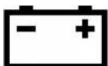
Il simbolo raffigurato, se collocato su una spia di colore rosso, permette di capire se la batteria viene correttamente ricaricata o meno dall'alternatore
