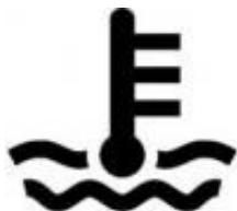
Il simbolo raffigurato è collocato sulla spia che indica l'eccessiva temperatura del liquido di raffreddamento del motore
