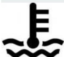
Il simbolo raffigurato è posto su una spia che, se accesa, segnala l'eccessiva temperatura dell'olio di lubrificazione del cambio di velocità
