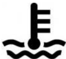
Il simbolo raffigurato è posto sulla spia luminosa che indica la temperatura dell'olio di lubrificazione del motore
