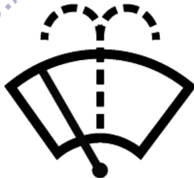
Está colocado en un interruptor que controla tanto el lavaparabrisas como el limpiaparabrisas: por lo tanto, se distingue el control del limpiaparabrisas delantero, que es un dispositivo para limpiar el parabrisas, lavándolo.
