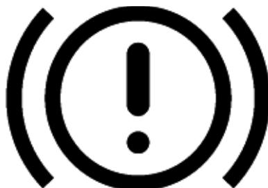
Símbolo de mal funcionamiento del sistema de frenos
