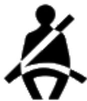
El símbolo que se muestra se coloca en una luz de advertencia roja que, si se enciende durante la conducción, indica que el conductor o un pasajero no están usando los cinturones de seguridad, en cuyo caso se combina con una señal acústica.
