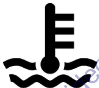
*Se coloca en una luz roja que indica que la temperatura del agua supera los límites establecidos por el fabricante, por lo tanto, indica un calentamiento excesivo del agua y, en consecuencia, también del motor; completa el indicador de temperatura del agua.*
