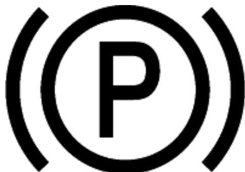
Se reproduce en un testigo rojo que, cuando se enciende, indica que el freno de estacionamiento (freno de mano) está puesto.
