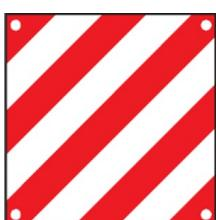
Se il carico sporge longitudinalmente per l'intera larghezza della parte posteriore del veicolo, i pannelli in figura devono essere due, posti trasversalmente alle due estremità del carico
